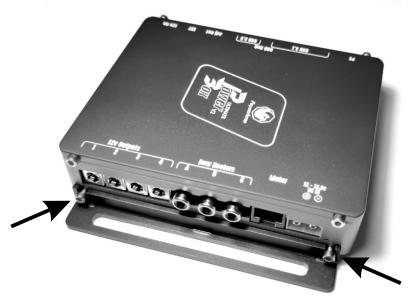
DO NOT USE THE OLD SCREWS AS THEY DO NOT FIT ON THE NEW ENCLOSURE
